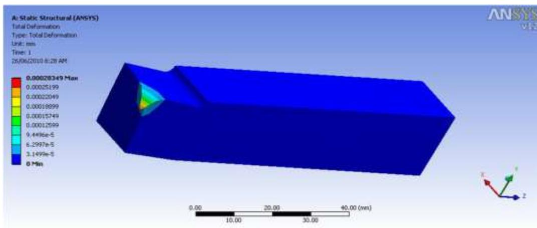
Displacement  $\rightarrow 2.8349 \times 10^{-4} \text{ mm}$
