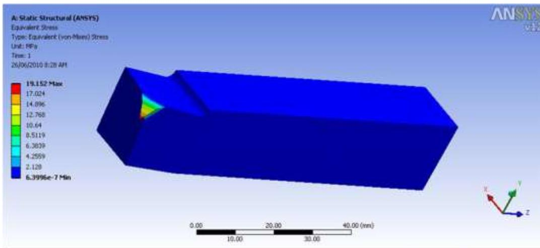
Max. Stress  $\rightarrow 19.152 \text{ N/mm}^2$  & Min. Stress  $\rightarrow 6.339 \times 10^{-7} \text{ N/mm}^2$
