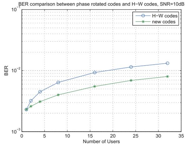
Fig. 9. BER vs  $K$ , SNR=10dB
