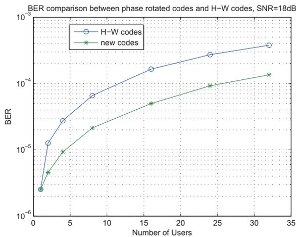
Fig. 8. BER vs  $K$ , SNR=18dB
