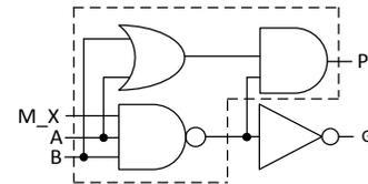
Fig. 2. A carry-maskable half adder.
