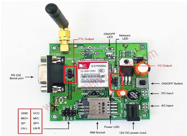
Fig.5. GSM module
