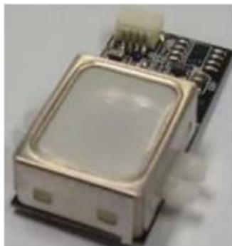
Fig. 9 Fingerprint module (GT-511C1R).
